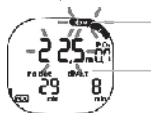
L'icône RALENTIR (slow) et l'indication de la profondeur actuelle clignotent pendant 6 secondes, et une alarme sonore résonne pendant 3 secondes.
