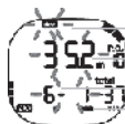
L'icône DECO, l'indication de la profondeur actuelle, de la profondeur du palier de décompression et du temps de palier de décompression clignotent, et une alarme sonore résonne deux fois, trois secondes à chaque fois.
